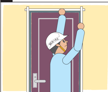
枠の周りにシーリングを施し、雨水の侵入を防ぎます
