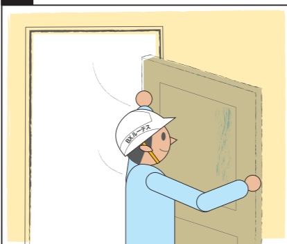
既存扉を撤去し、養生を行います
