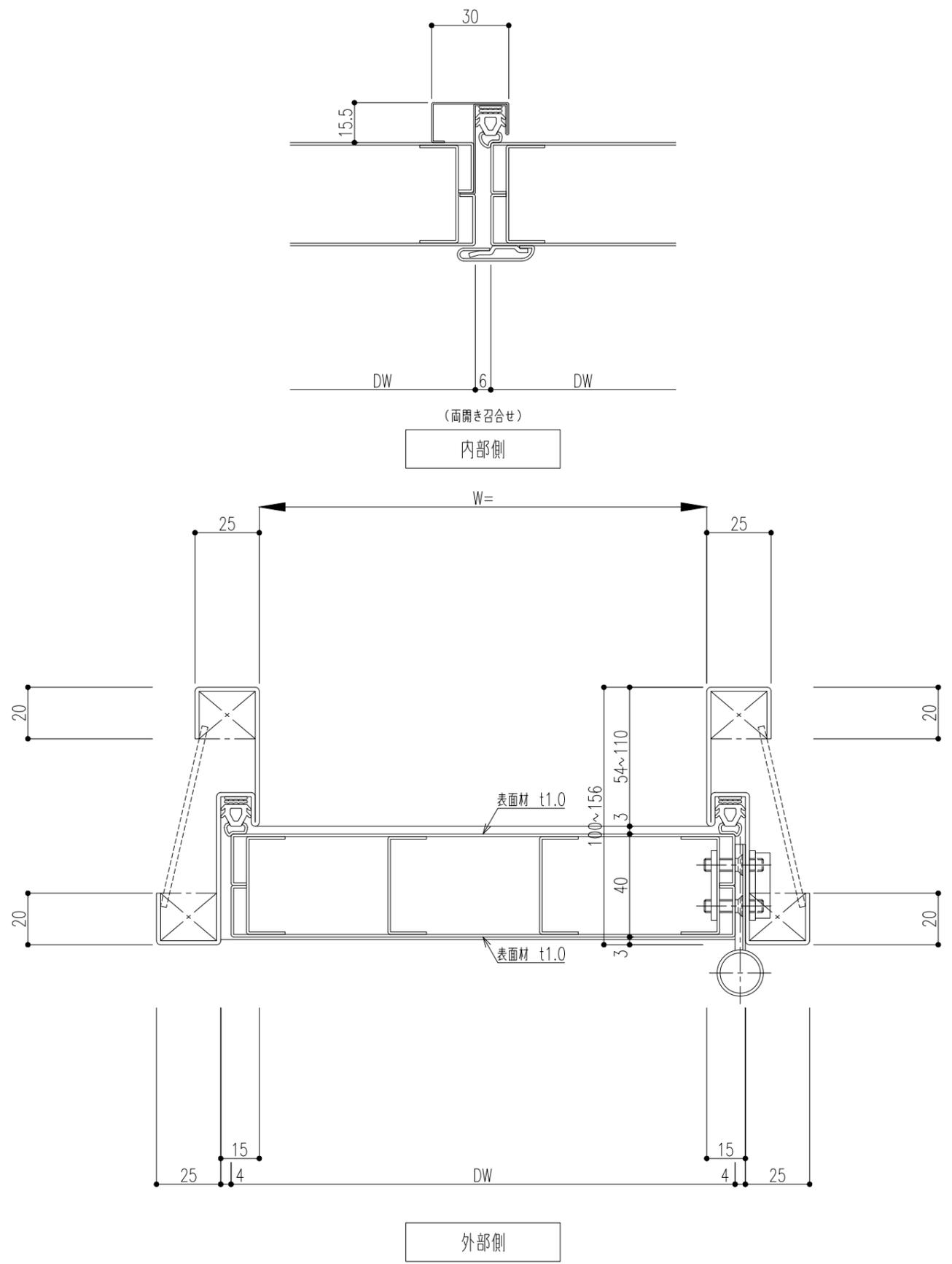
\*本図は右吊元の場合を示し、左吊元は本図と左右対称とする。
