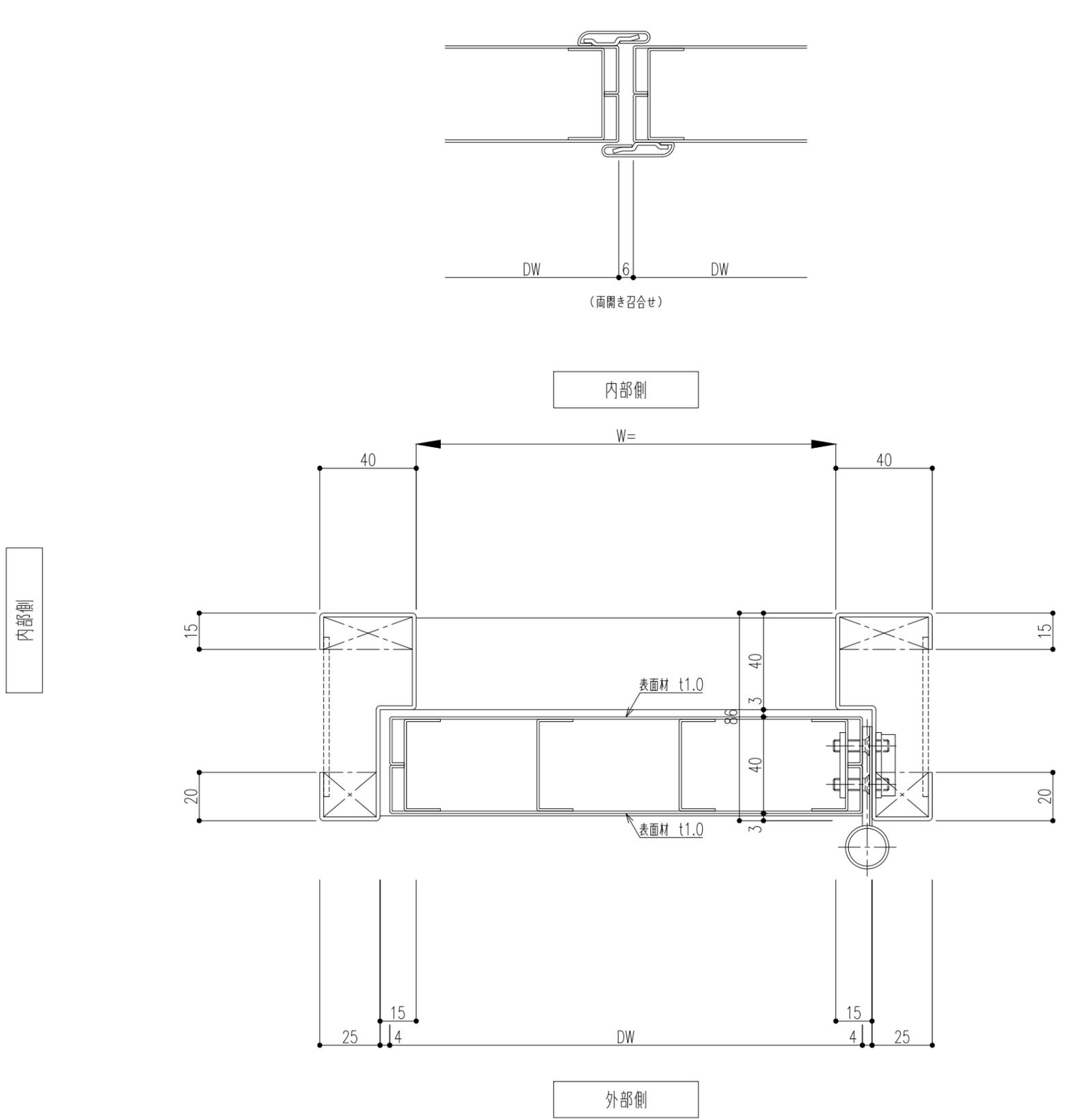
\*本図は右吊元の場合を示し、左吊元は本図と左右対称とする。
