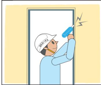
下地の取り付け後、新規枠を取付けます
