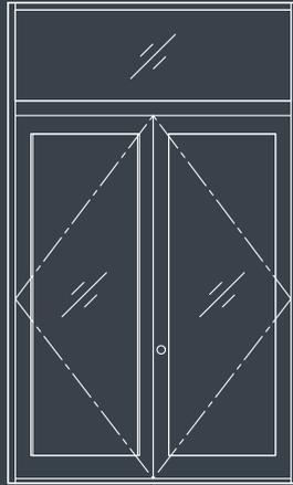
耐熱ガラス入り特定防火設備として高い防火性能を発揮し、多彩なバリエーションに対応するエリファイトクリア。国土交通大臣の認定を取得しており、安心してお選びいただけます。
